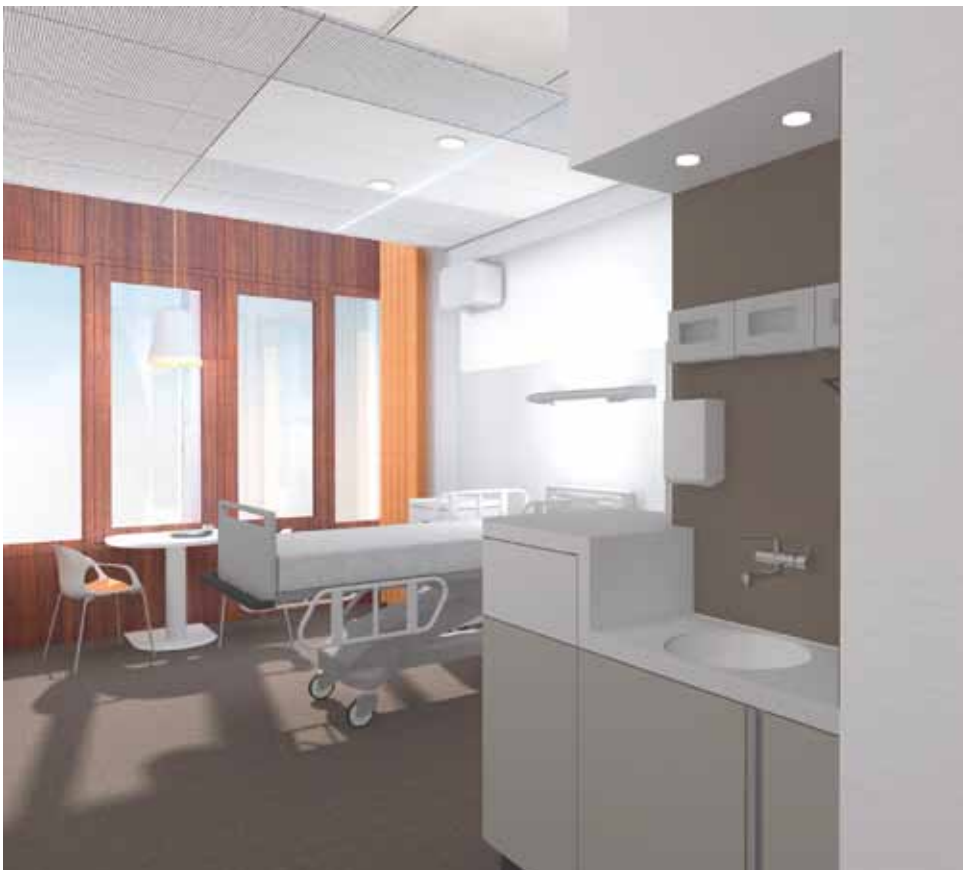
Klimaatplafond in verpleegkamer nieuwbouw Erasmus MC.
